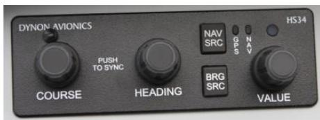
**Per individuare la radiale su cui il velivolo si trova occorre ruotare la manopola " COURSE " dell' HS34 fino a che la barra centrale si posiziona al centro, CON LE FRECCE NELLA STESSA DIREZIONE, come nella figura sottostante. Il valore della radiale si legge sulla coda dello strumento. La prua per raggiungere la stazione è indicata dalle frecce.**
